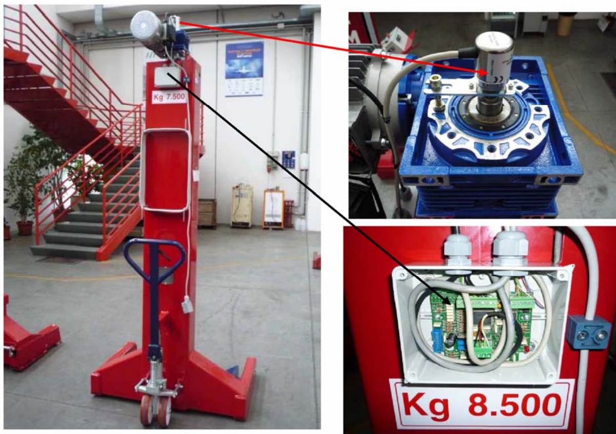
COLONNA CON DETTAGLIO ENCODER ASSOLUTO E SCHEDA MICROPROCESSORE
